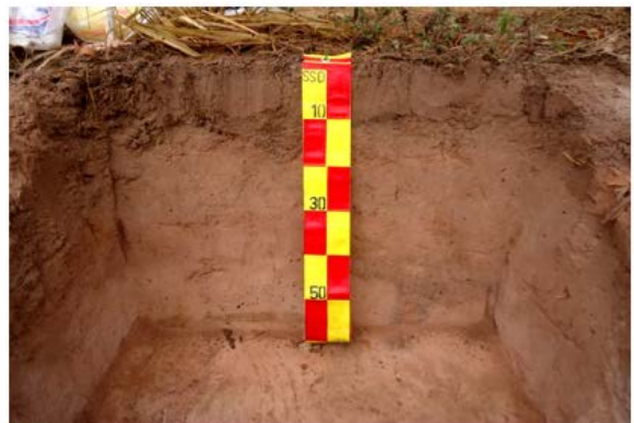
ภาพที่ 4-2 หลุมหน้าตัดดินขนาดเล็ก ขนาดกว้าง 50 เซนติเมตร ยาว 50 เซนติเมตร และลึก 50 เซนติเมตร
